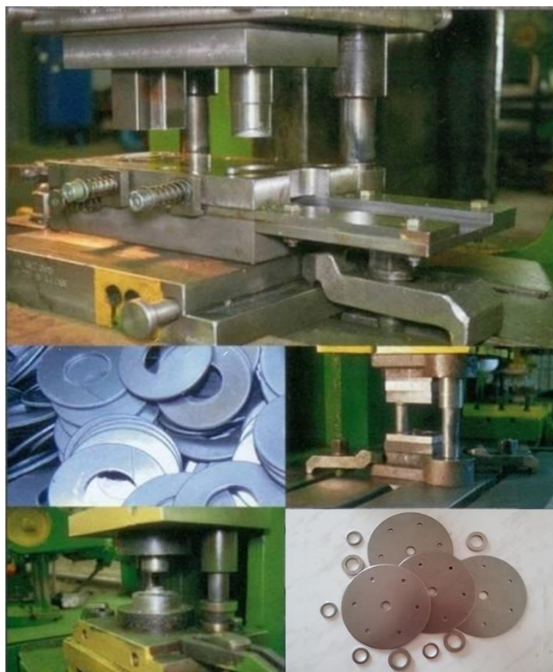
1.1 Сурет- Суық штамптау тәсілімен бұйымдар дайындау процесі
